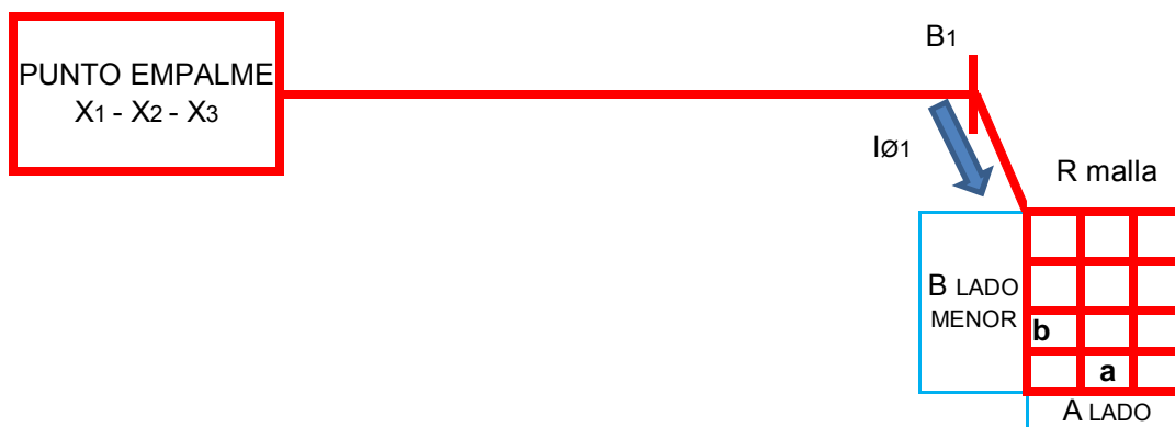
Fig. 6.a ) La figura muestra un sistema simplificado de cortocircuito en la barra B1.
